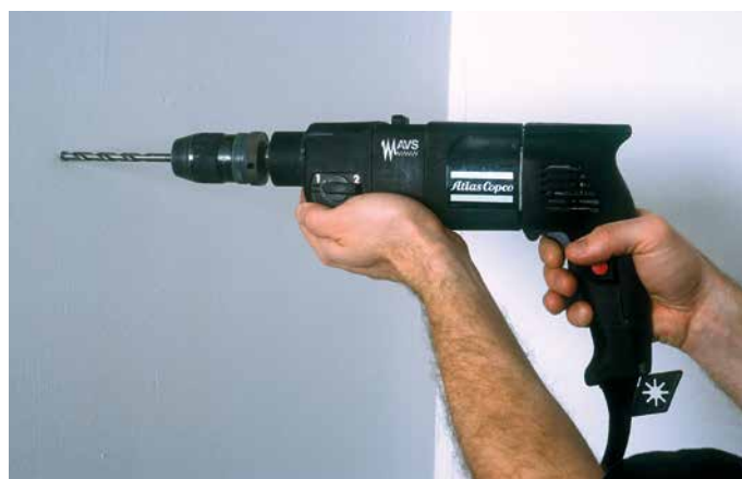
Een klopboormachine heeft meestal twee instellingen: mét en zonder kloppen.
