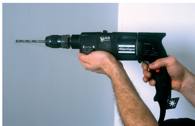
Een klopboormachine heeft meestal 2 instellingen: met en zonder kloppen.
